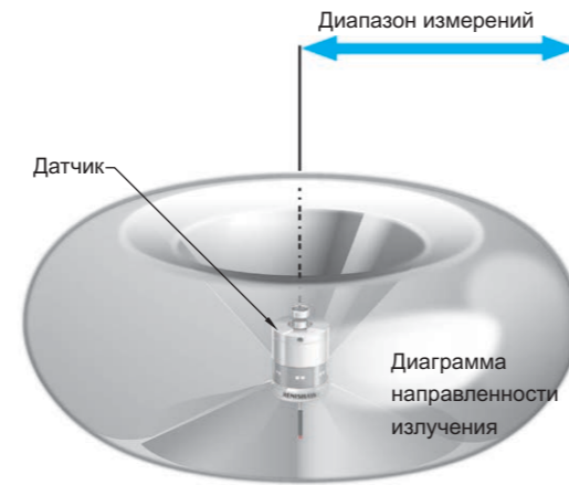
Оптические датчики компании Renishaw имеют диаграммы направленности, охватывающие 360° и напоминающие по виду тор неправильной формы.
