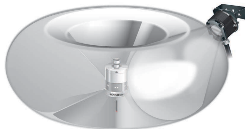
Настройка оптических систем выполняется таким образом, чтобы происходило перекрытие диаграмм направленности датчика и интерфейса.
